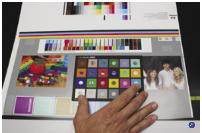
Рис. 3. Фрагменты проводимых в лаборатории качества типографии «Промис» работ: а — взвешивание требуемого количества краски; б — получение тестовой полосы на пробпечатном офсетном станке; в — измерение цветовых характеристик тестовой полосы спектрофотометром; г — визуальный тест правильности воспроизведения цветов на печатном оттиске
